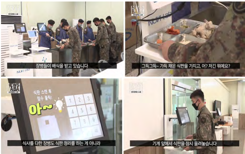
<그림 1> 3D 스캐너를 이용한 배식량, 급식량 측정기
