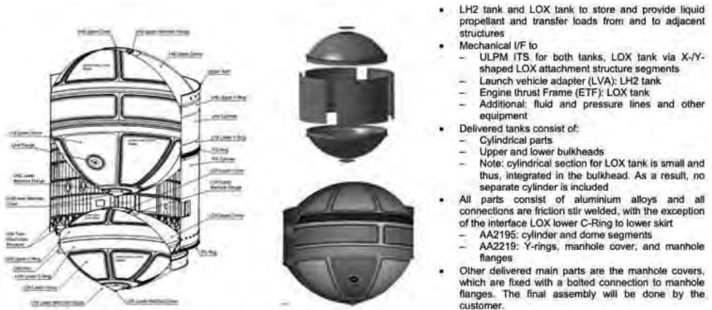
〈그림 14〉 아리안 6 LH2와 LOX 탱크에 적용된 Al2129 알루미늄-리튬 합금 및 마찰교반 용접 적용 부위 2)
